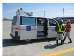
FWDによる支持力調査 (平成23年東北地方太平洋沖地震)
