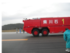
大型消防車を用いた支持力調査 (平成19年能登地震)
