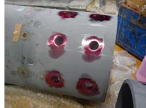
(a) 管部材の浸透探傷試験
