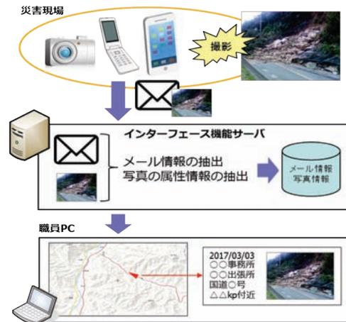
図4 災害時に撮影した写真データを共有するシステム図
