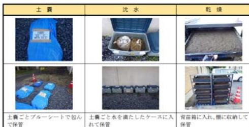
写真2 表土の保管(土嚢、沈水、乾燥)
