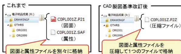
図 1 CAD 製図基準改訂の概要
