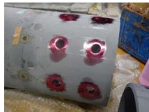
(a) 管部材の浸透探傷試験
