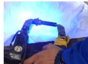
(b) ボルトの磁粉探傷試験
