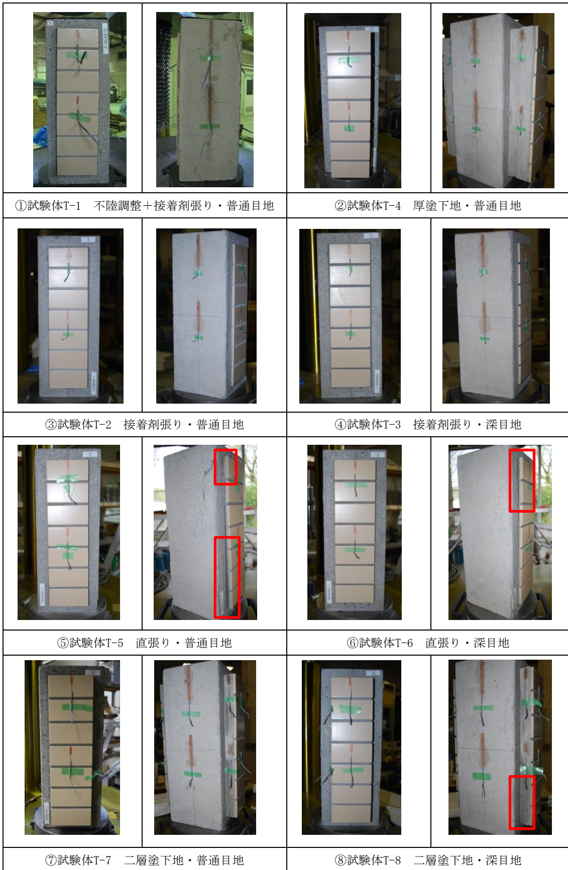
写真4.5.1 変形追従性試験の載荷終了後の状態
