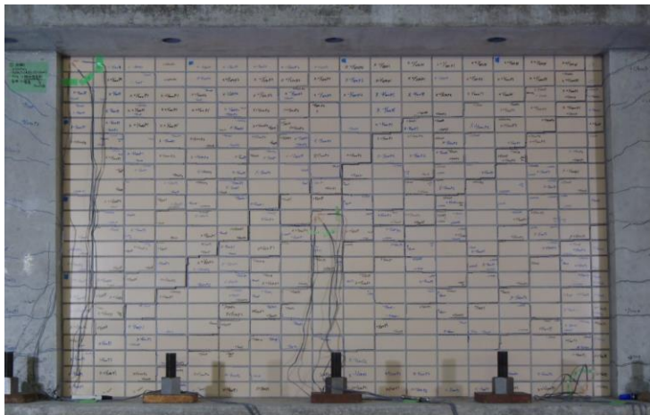
No. 1 不陸+接着材・普通目地
