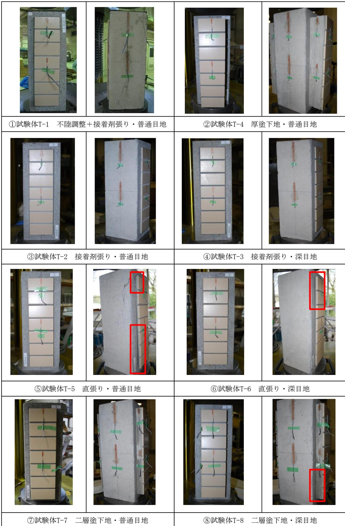
写真4.5.1 変形追従性試験の載荷終了後の状態
