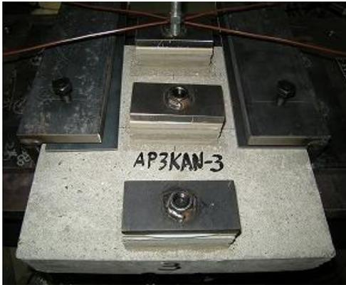
写真 4.6.1 引張接着性試験
