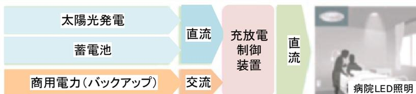
図 4-8 太陽光発電＋直流給電 概念図<sup>5)</sup>
