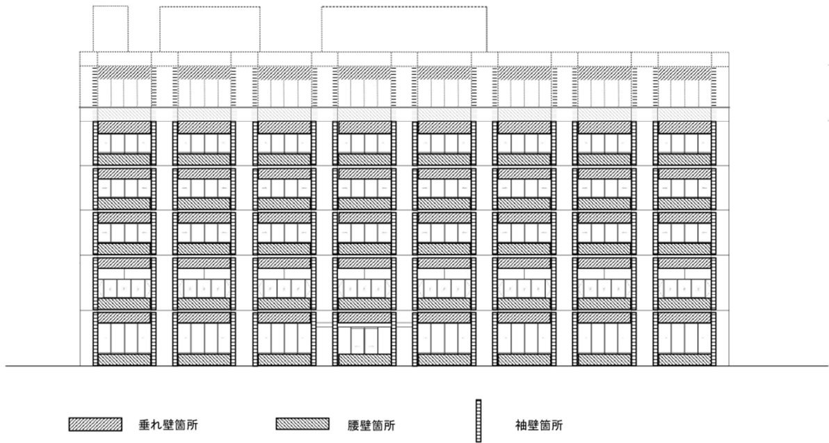
図 6-2 内陸型南立面図 (袖壁・垂れ壁・腰壁図示)
