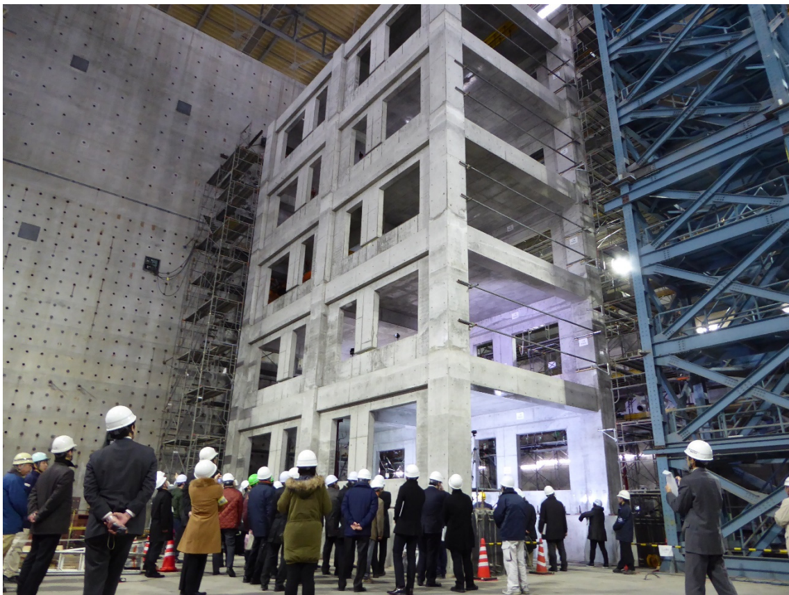
写真 6-1 (参考) 壁を活用した鉄筋コンクリート造建築物の損傷制御設計法の検証のために実施した実大 5 層 RC 造建築物の載荷実験
