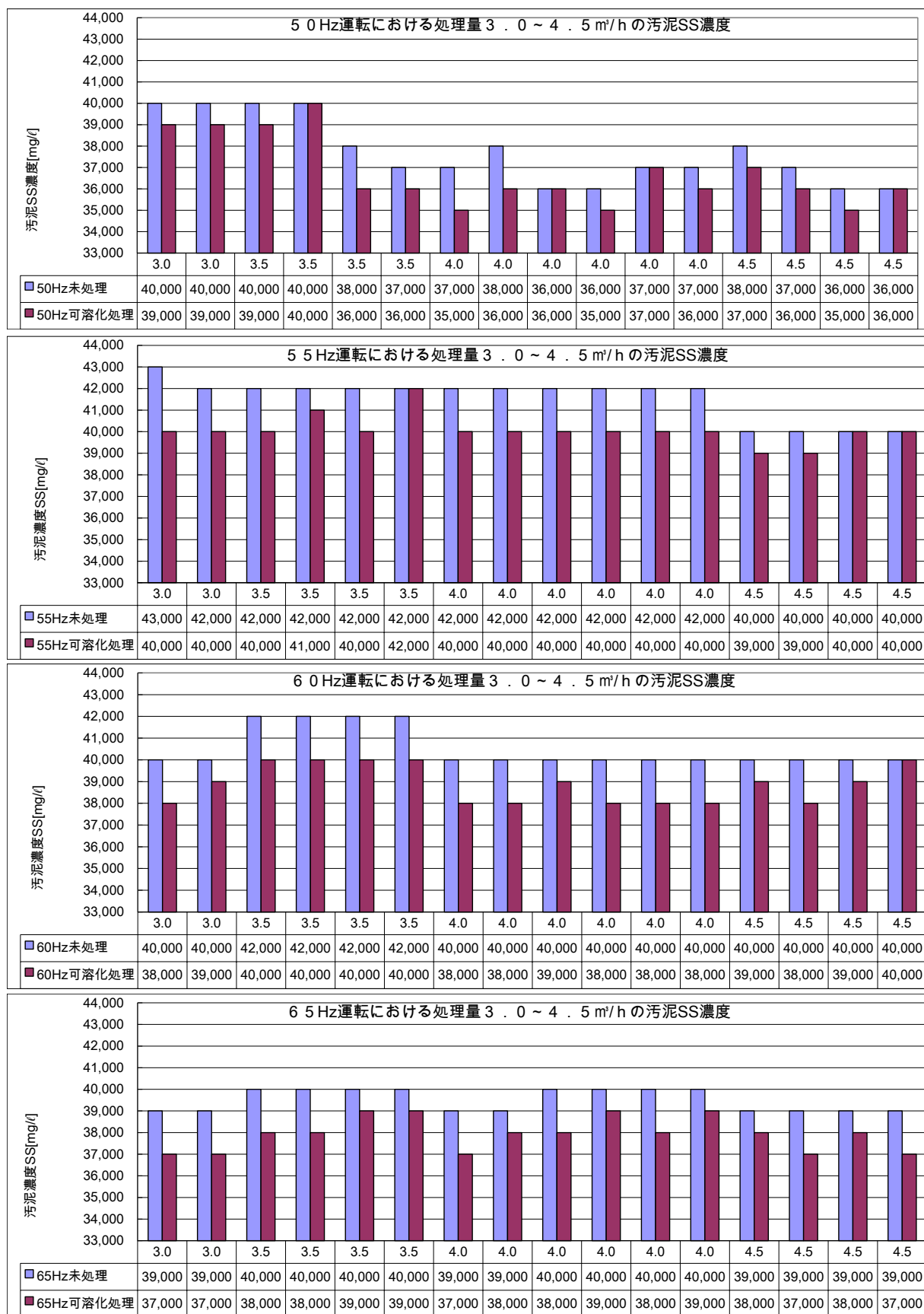
図 資-1-45 運転周波数50～65Hzにおける汚泥投入量に対するSS減少量
