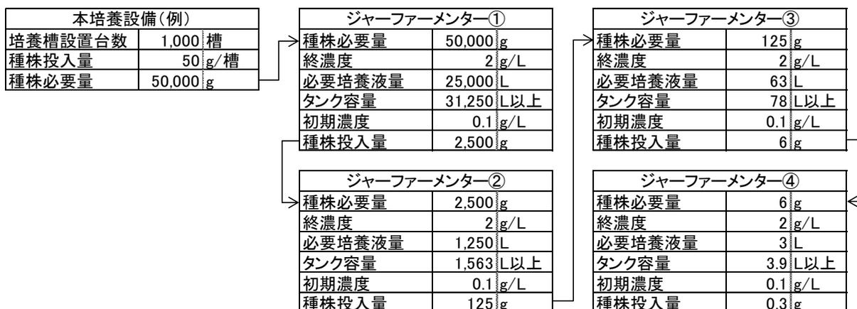
図 4-6 種株培養槽の設備規模算出方法の例
