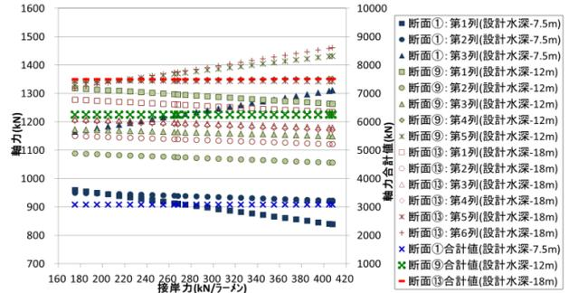
図-56 接岸力と軸力の関係<sup>13)</sup>
