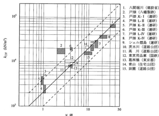
図-3 杭の水平荷重実験から逆算した $k_{CH}$ <sup>18)</sup>
