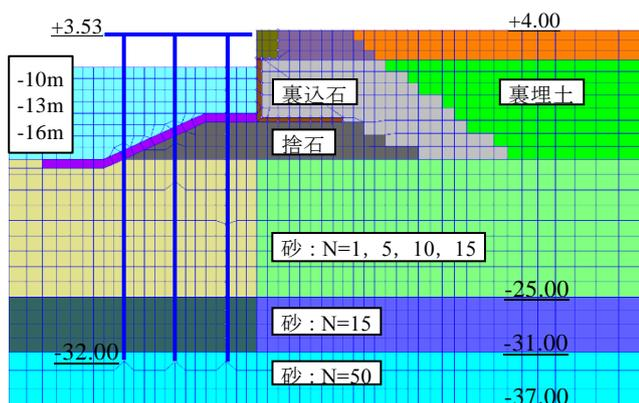
図-7 検討断面の概要
