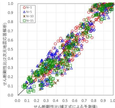
図-44 補正式による予測値と2次元地震応答解析とのせん断剛性比の比較
