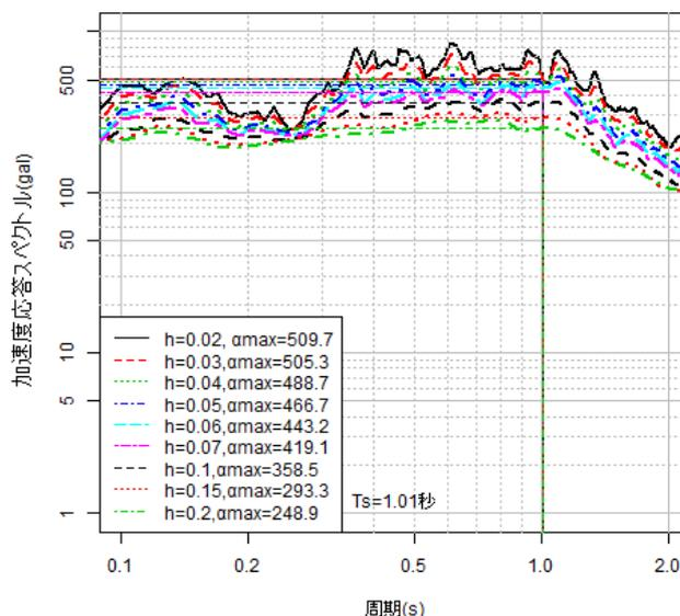
図-48 各減衰定数における加速度応答スペクトル
