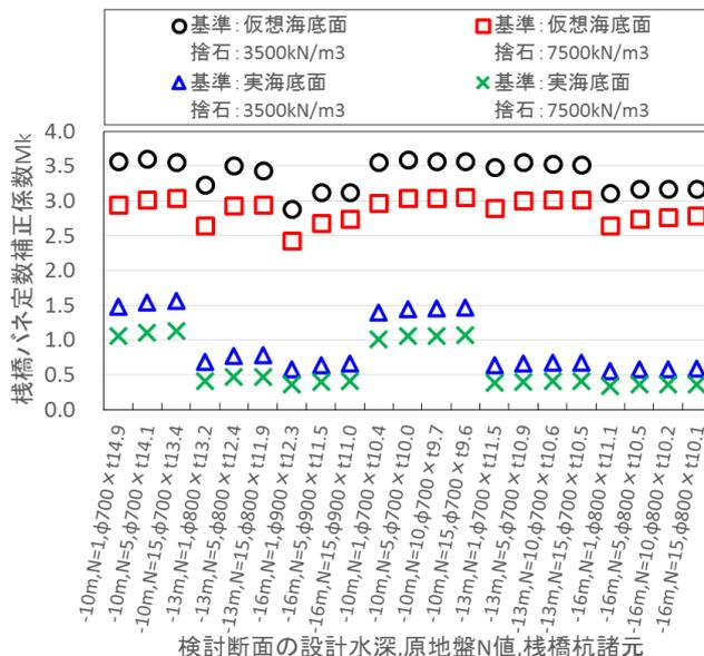
図-18 断面ごとの補正係数算出結果
