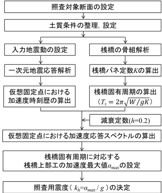
図-2 現行港湾基準における照査用震度の算出過程<sup>1)</sup>
