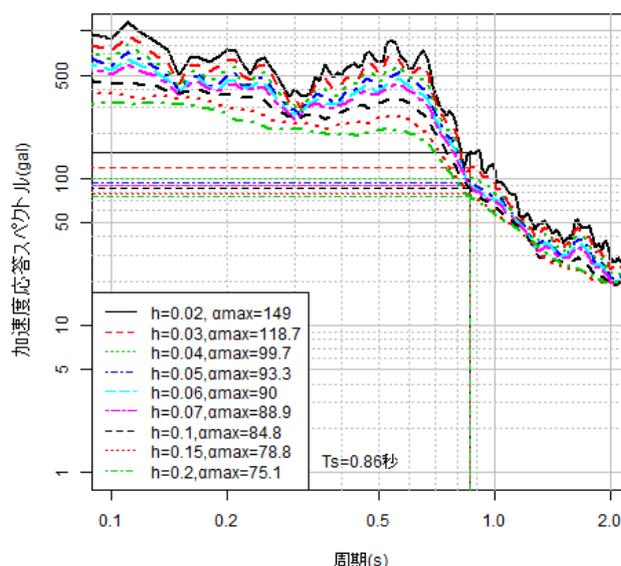
図-49 各減衰定数における加速度応答スペクトル
