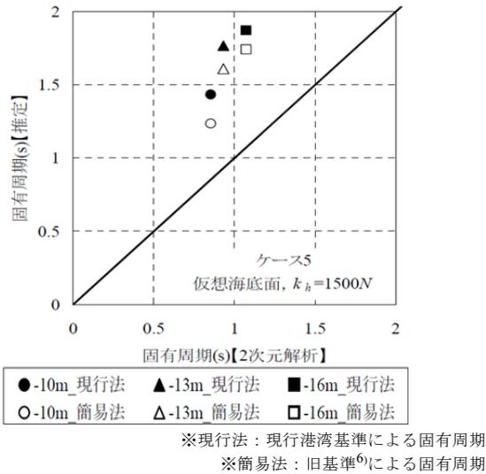
図-4 現行法と2次元解析の固有周期の比較<sup>5)</sup>
