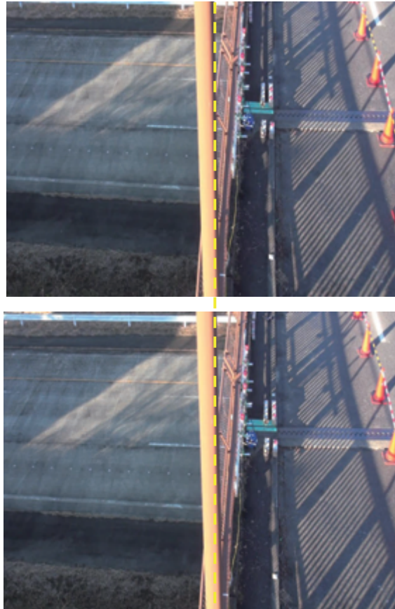
図-4.3.11 風によるカメラの角度のずれ
