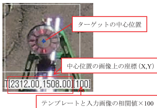
図-4.2.4 撮影画像および画像処理のイメージ（左：撮影画像、右：画像処理の様子）
