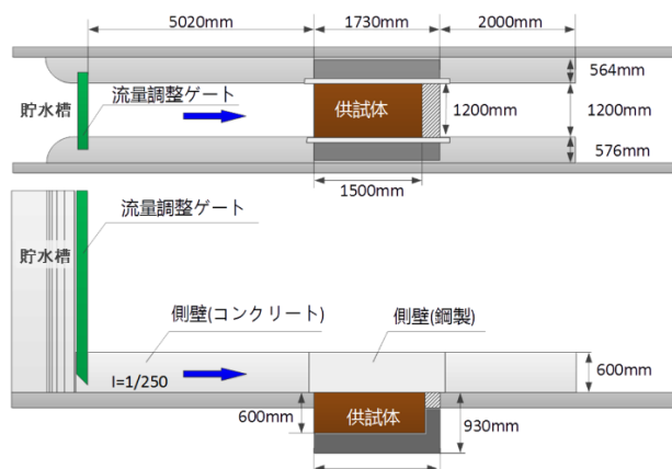
図-4 高流速実験水路の諸元
