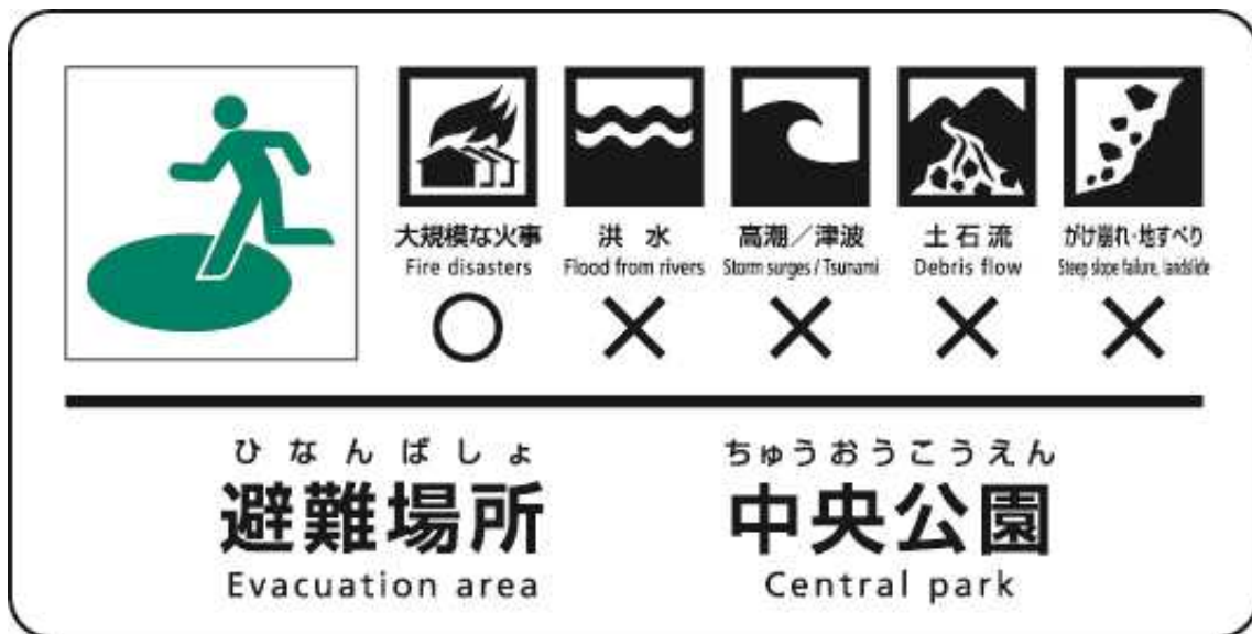
図Ⅲ-33 災害種別避難誘導標識システム記載例
