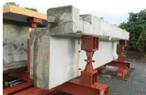
写真-3.1.4 供試体設置状況 (D橋)
