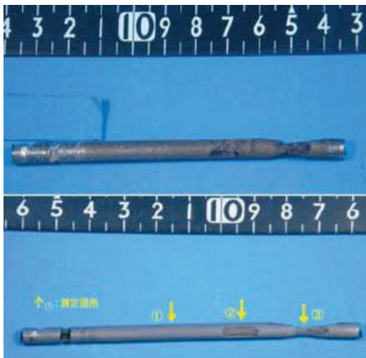
写真-3.1.9 C-6 供試体 PC鋼線 (ケーブルNO.4 試料NO.1)
