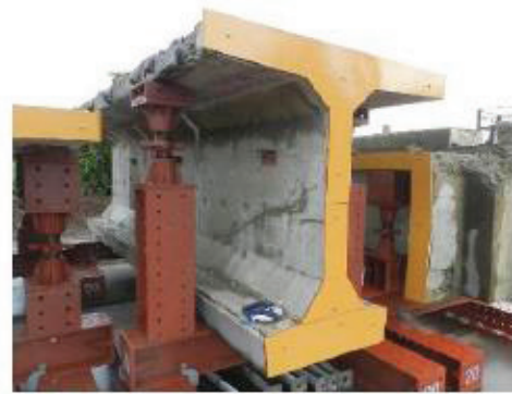
写真-3.1.1 供試体設置状況 (A橋)
