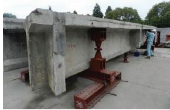
写真-3.1.3 供試体設置状況 (C橋)
