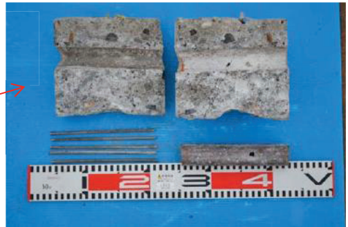
写真-3.1.6 切断後の桁断面 (C-6)
