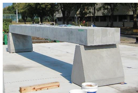
写真-3.2.2 模擬損傷供試体（D-3）
