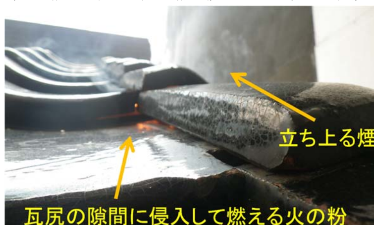
写真 5.3.2 風速 10m/s 実験時の瓦屋根上部
