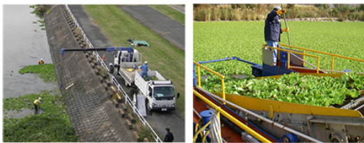
図-10 機械や清掃船による回収
