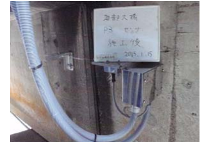
P7 桁端部支点部計測装置（橋軸方向計測）
