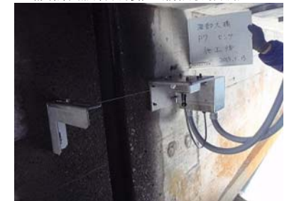
P7 桁端部支点部計測装置（橋軸方向計測）
