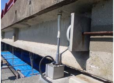
橋脚部 鉛直方向 桁端部支点部計測装置(下流側)
