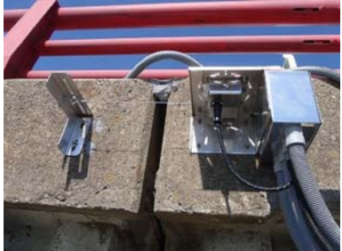
橋脚部 橋軸方向 桁端部支点部計測装置
