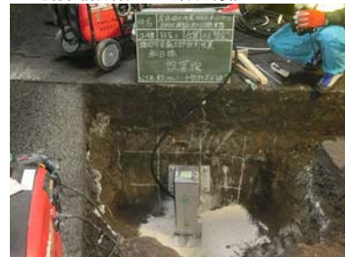
A1桁側面 桁端部支点部計測装置 (橋軸方向)
