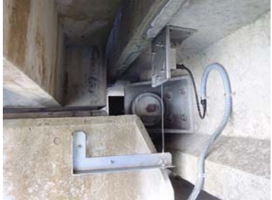
橋脚部 鉛直方向 桁端部支点部計測装置(上流側)
