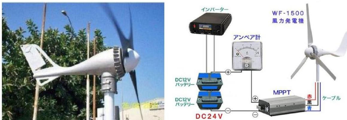
写真 2-3. 風力発電システムの全体イメージ
