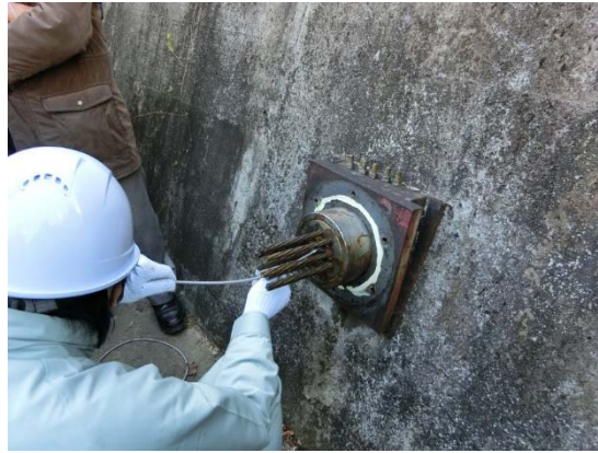
図 3.17 工業用内視鏡による調査状況
