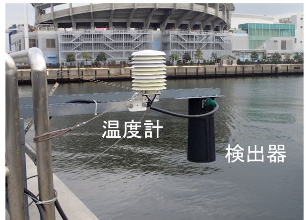
写真-B.4 超音波検出器, 温度計 (港外側)
