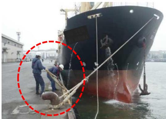
図 1.1 係船柱に船からの係留索を掛ける作業<sup>1)</sup>
