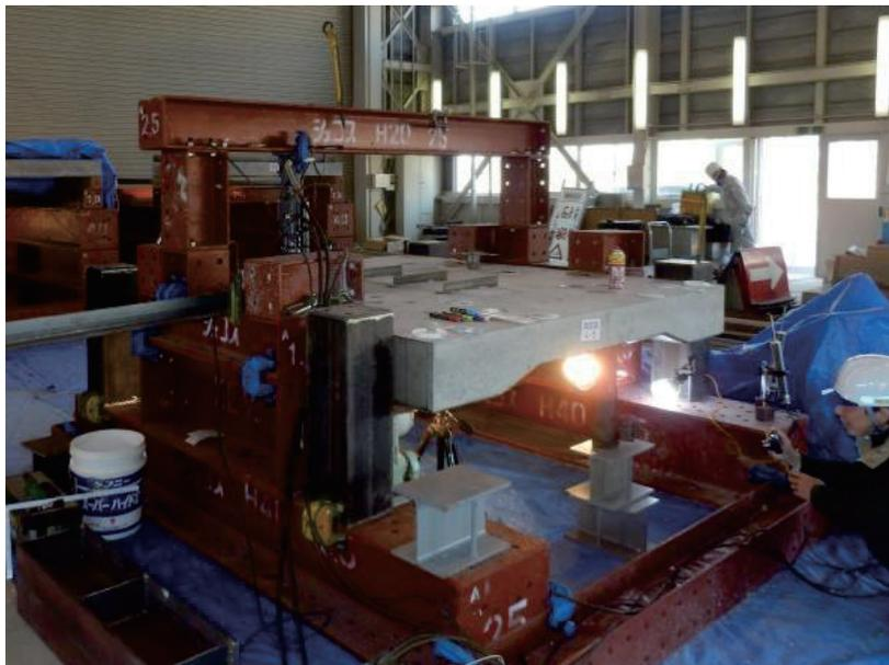
図 4.4.3 荷重装置の状況
