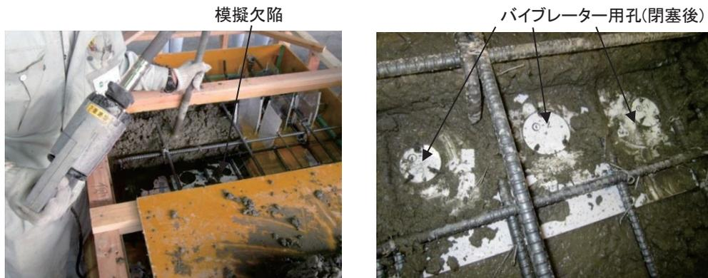
図 4.3.29 模擬欠陥（うき）の作製状況
