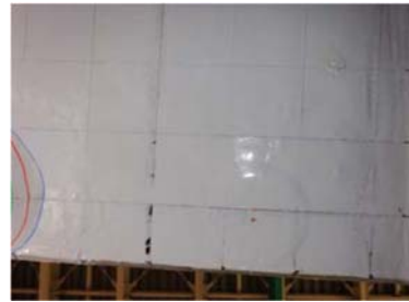
(a) 固定モルタル破損時
