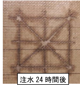
図 4.5.104 漏水検知性能試験結果 (その 2)
