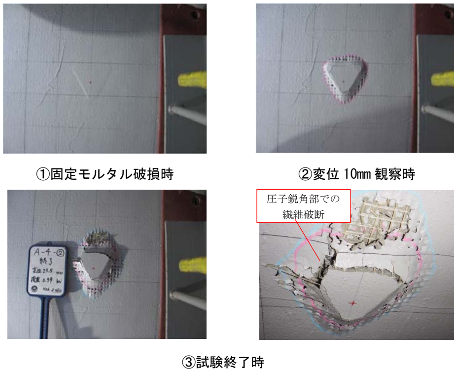
図 4.5.18 試験状況 (case2D)
