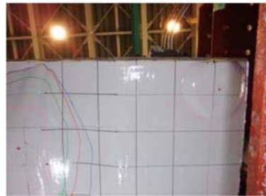
(a) 固定モルタル破損時
