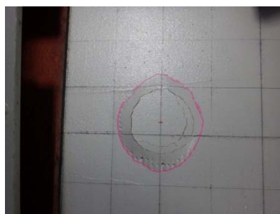
③載荷時 (繊維シートの露出)
