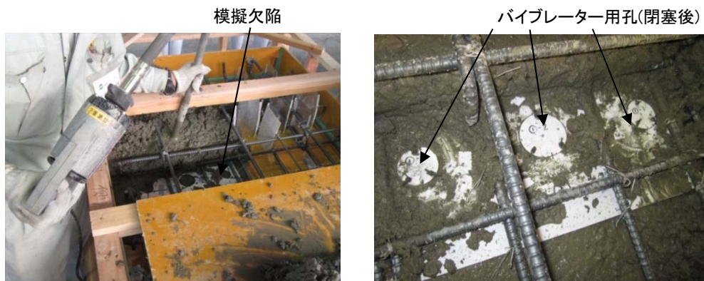
図 4.3.29 模擬欠陥（うき）の作製状況
