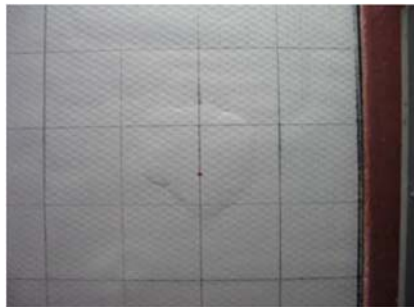
①固定モルタル破損時
