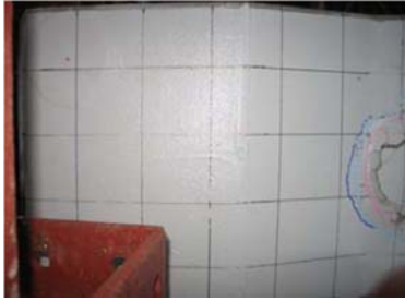
(a) 固定モルタル破損時
