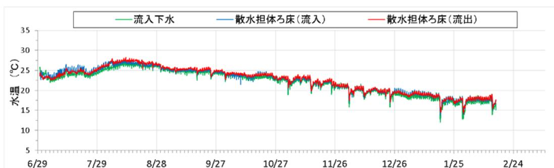
図 2-19 流入下水、散水担体ろ床の流入・流出水の各水温（夏季～冬季）
