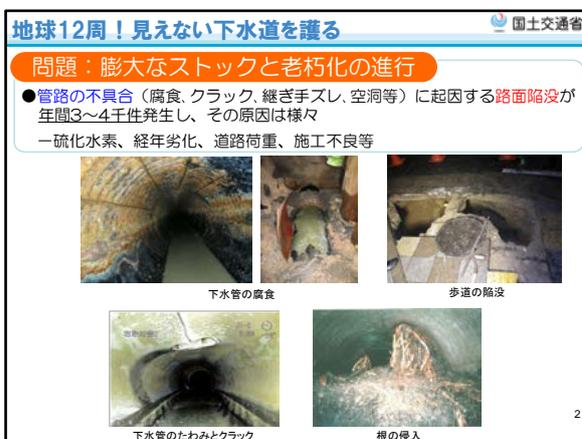
どのような不具合が起きているかということでございますけれども、腐食、クラック、継ぎ手ずれ、空洞等に起因して路面陥没が年間3,000~4,000件発生しております。ここにあります写真ですけれども、これは硫化水素による管渠の腐食。下水というのは硫酸イオンが含まれておりますけれども、溶存酸素がなくなると、硫化水素に変わってまいります。その硫化水素は空気中に出て、このような壁面につ
