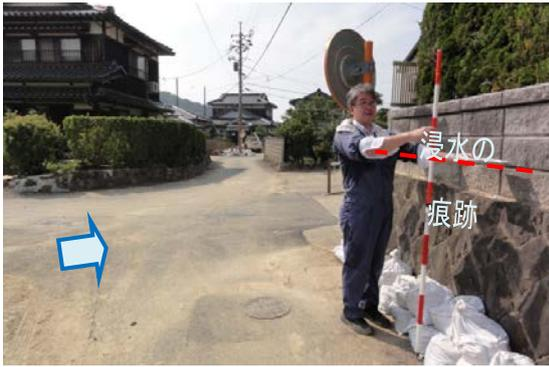
写真-2.2.31 堤内地の浸水状況 (8月5日調査)
