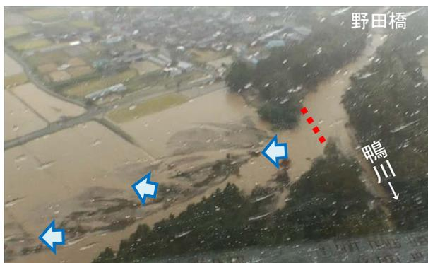
写真-3.2.8 鴨川右岸の堤防決壊部の氾濫流
