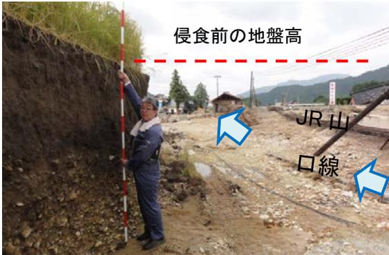
写真-2.2.11 氾濫流により約2.6m 侵食された水田
