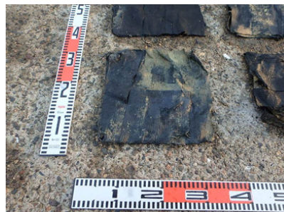
写真-3.16 現地採取ペトロラタム系防食材
