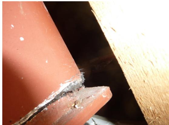
写真 5.4-21 パネルとダイアフラム間の溶接部の破断 (拡大)
