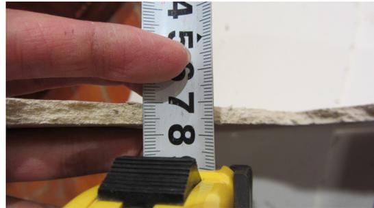
写真 5.4-104 落下した舞台上部内壁の仕上げ材
