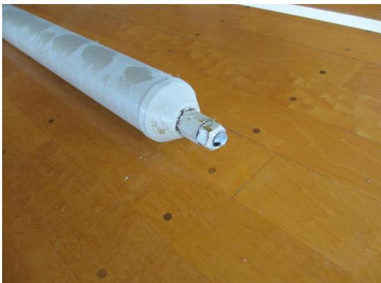
写真 5.4-155 落下したトラス下弦材
