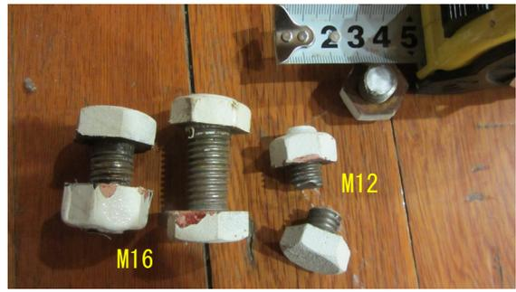
写真 5.4-102 屋根面水平ブレース用のボルト
