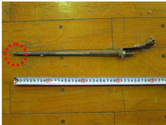
写真 5.8.2-18 吊り材(円内は溶接痕)
