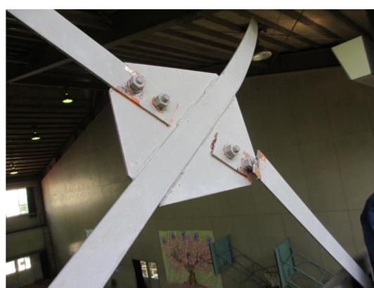
写真 5. 4-166 孔欠損部での破断
