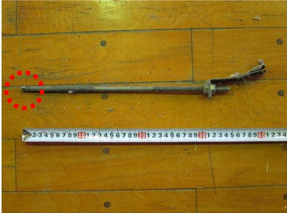
写真 5.4-169 吊り材（円内は溶接痕）
