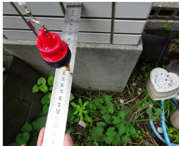
写真5.5-78 下げ振りによる柱の傾斜測定
