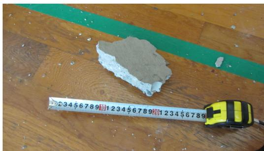
写真 5. 4-146 落下していたモルタル
