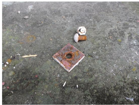
写真 5.4-94 破断した交差部のボルトとブレースの間に挿入されていたプレート
