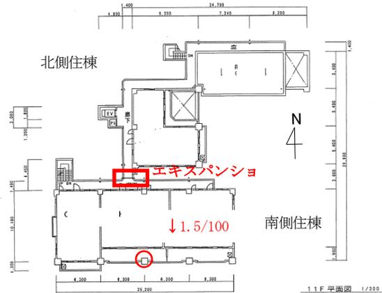
図5.5-22 傾斜の測定位置・傾斜角(11階)
