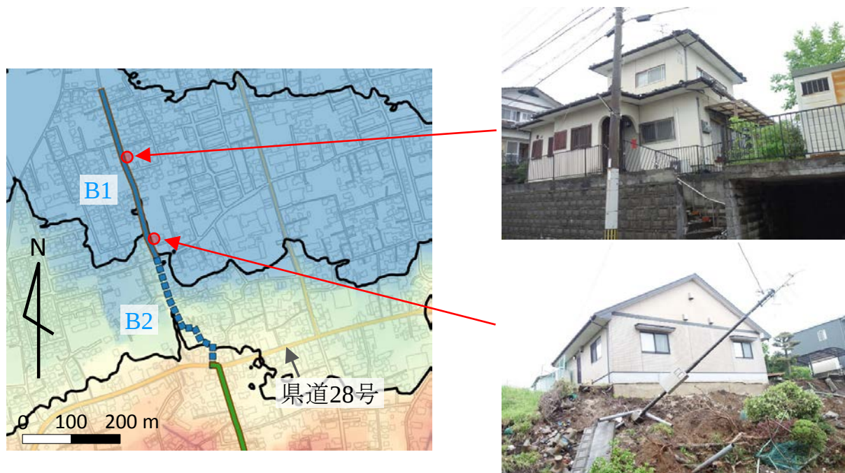
写真 5.6-42 県道 28 号線北側の ZoneB1 で見られた盛土擁壁の被害事例
