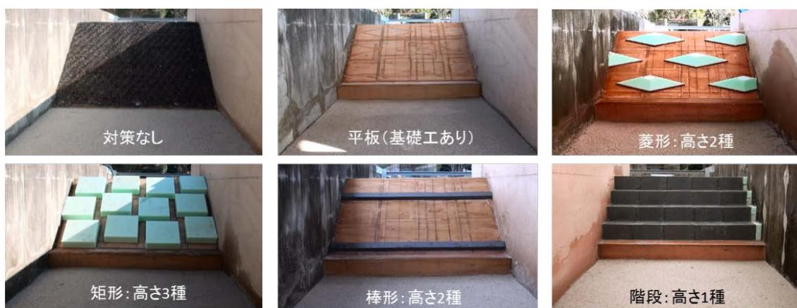
写真-3 のり尻補強工の縮尺模型実験
