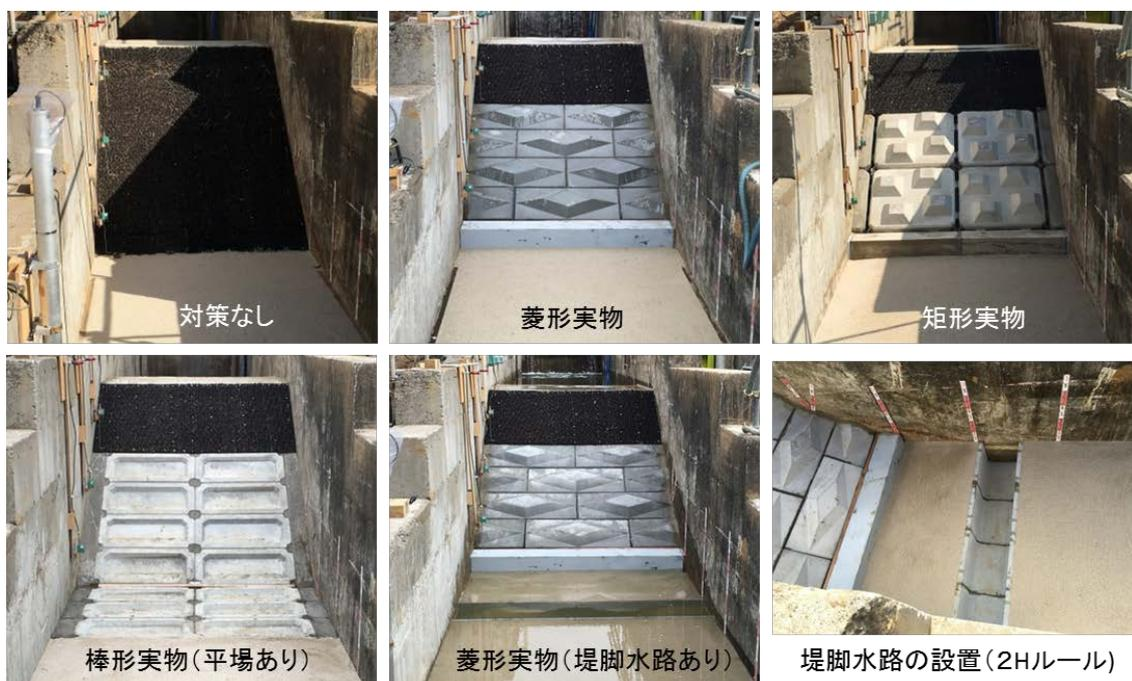
写真-4 のり尻補強工の実大水路実験
