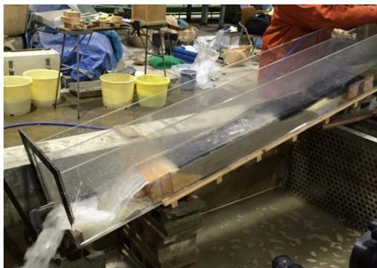
写真-5 ブロック端部を抽出した移動床水路模型実験
