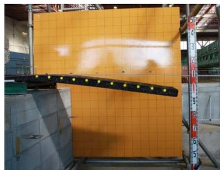
写真-2 ひさし保持強度試験
