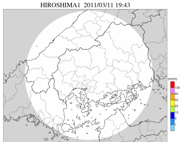
図 3.74 補間処理を適用後の遮蔽域の出現状況 (牛尾山局、仰角：1.4 度、遮蔽の判定閾値：55%)
