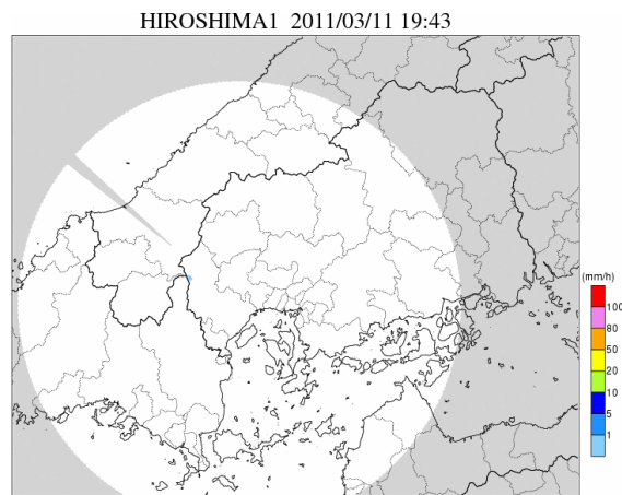
図 3.63 補間処理を適用後の遮蔽域の出現状況 (野貝原局、仰角：1.5 度、遮蔽の判定閾値：55%)
