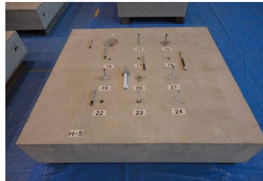
写真-6.1.3 引張試験状況
