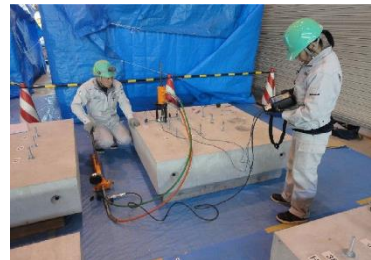
写真-6.1.3 引張試験状況
