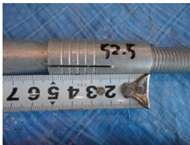
写真-3.2.19 切断後のスリーブ長 (M16)
