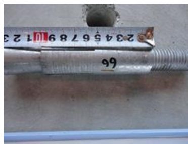
写真-3.2.20 切断後のスリーブ長 (M24)
