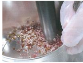
写真-3.2.9 樹脂攪拌状況（加水）
