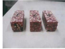
写真-3.2.10 供試体（圧縮試験前）
