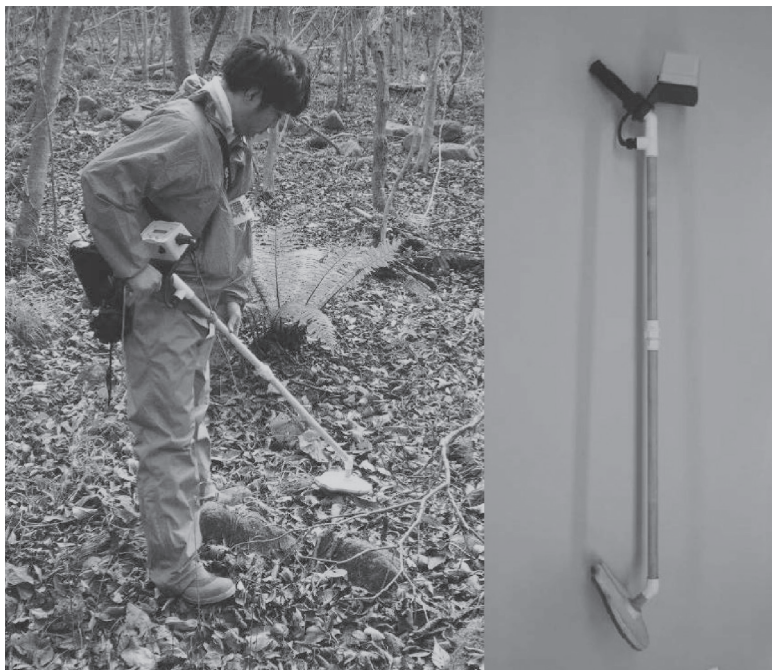
図2 移動式ポールリーダーによる探索
