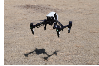
図-2 空撮に使用している小型 UAV
