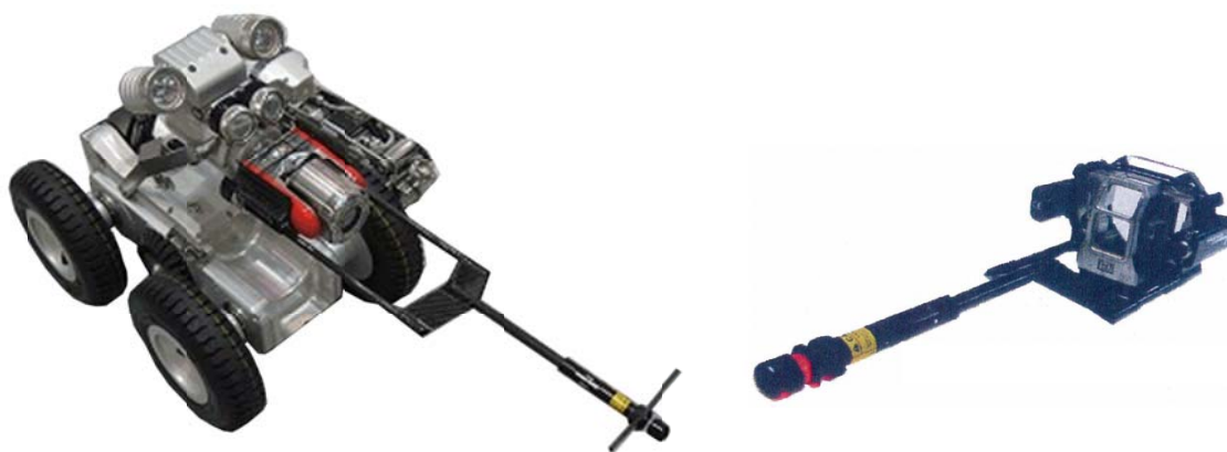
図 5-13 管路形状プロファイリング装置の外観 (左：カメラ装着時，右：装置単体)
