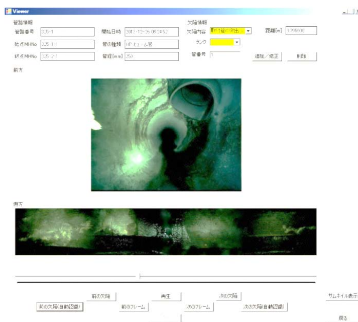
図 4-14 専用ソフトウェアによる自動検出結果およびランク入力画面
