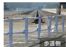
実験結果：最大変形量が約9cm。衝突車両を円滑に誘導
