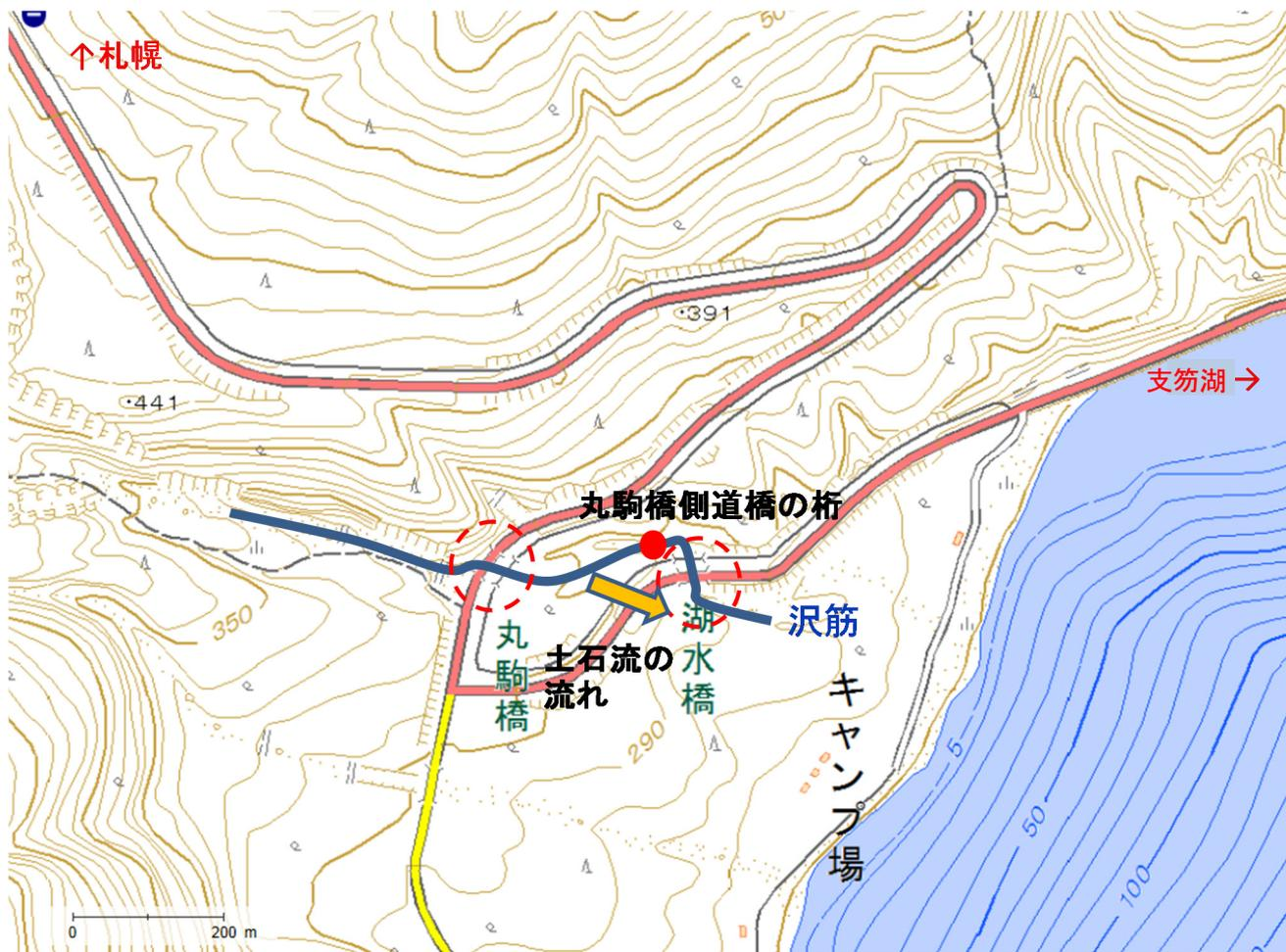
図- 1.5.12 丸駒橋・湖水橋周辺の地形と流失した側道橋の桁の位置図
