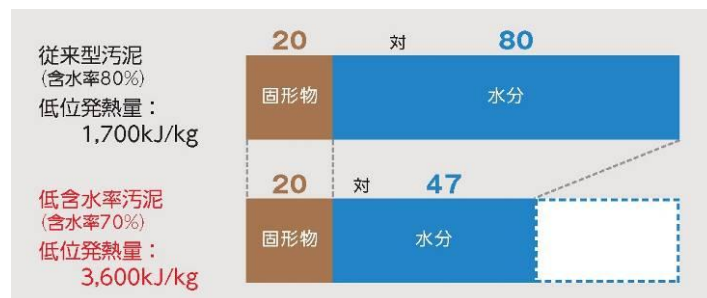
図 2-9 汚泥低含水率化による発熱量増加の例
