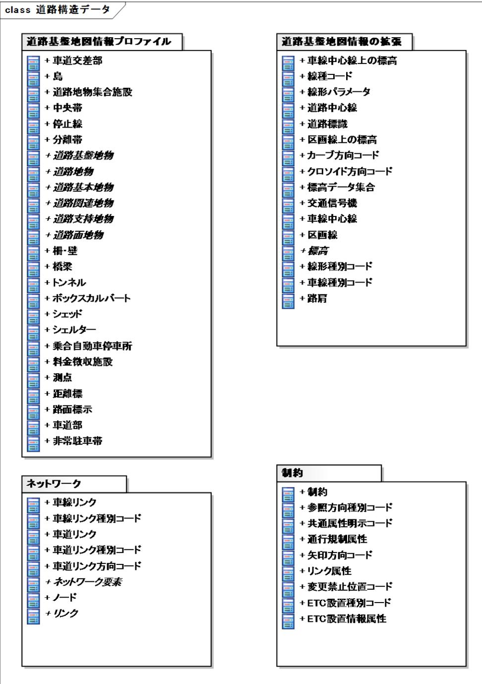
図 4 道路構造データパッケージの構成
