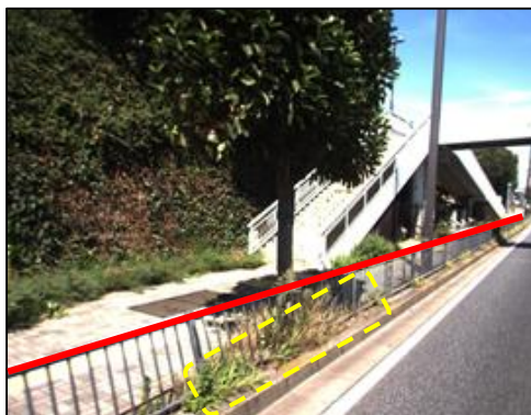
図 19 設置位置が取得できない場合の横断防止柵の取得例
