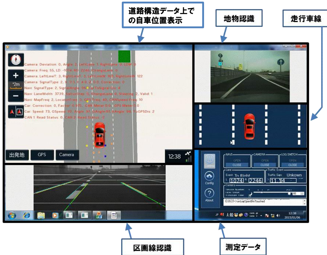
図 3-24 走行実験システムの画面表示例
