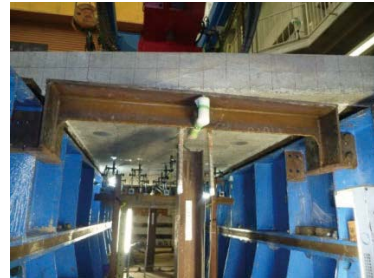
(a) 試験体の支持構造(橋軸方向) (b) 橋軸方向支持(単純支持(回転可能)) (c) 橋軸直角端部の横桁
