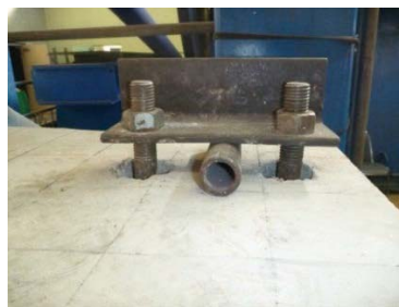
(d) 試験体の支持構造(橋直方向) (e) 上側(弾性支持) (f) 下側(弾性支持)
