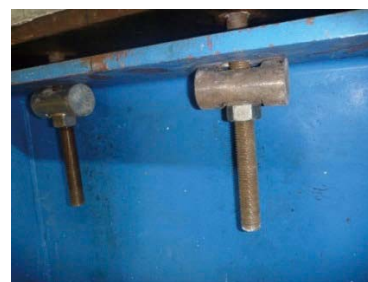
(d) 試験体の支持構造(橋直方向) (e) 上側(弾性支持) (f) 下側(弾性支持)
