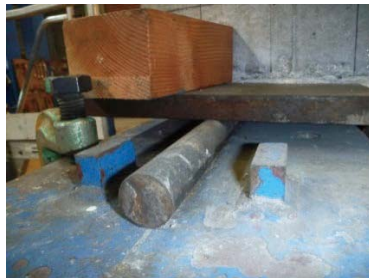
(a) 試験体の支持構造(橋軸方向) (b) 橋軸方向支持(単純支持(回転可能)) (c) 橋軸直角端部の横桁
