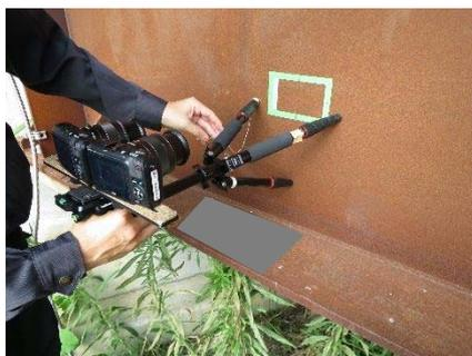
図-3.8 耐候性鋼橋に対するカメラの配置状況の例
