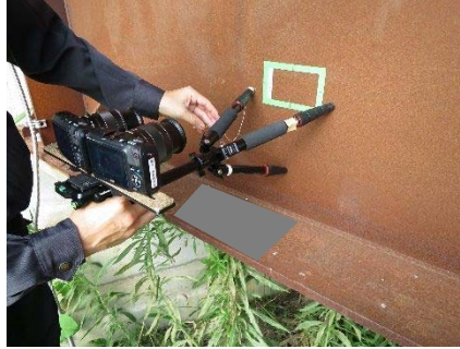
付図-6 耐候性鋼橋に対するカメラの配置状況の例
