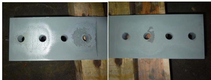
図-3.3.38 連結板トレース図 (供試体 No. 56-2)
