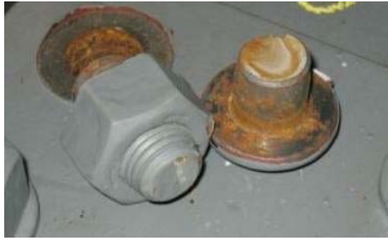
図-1.2 高力ボルト(F11T)の遅れ破壊
