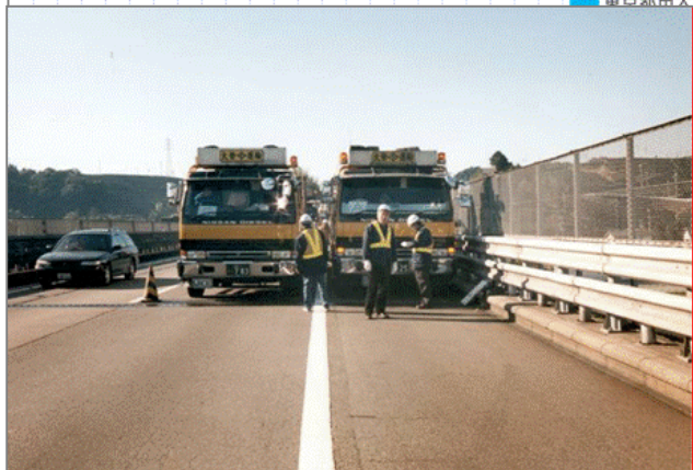
もっと重たい荷重(B活荷重のレベル)での試験 土論 6.847(2004)
