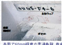
表面で60mm程度の真通亀裂、寿命の90%
