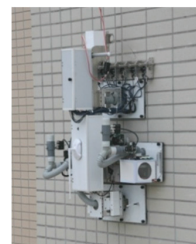
壁面走行型外壁診断装置(試作機)
